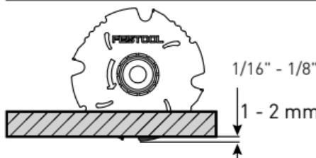
Ajustar la profundidad de corte según el espesor de la pieza de trabajo; rebase de diente de  $1/16" - 1/8"$  (1-2 mm).
