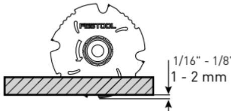
Régler la profondeur de coupe selon l'épaisseur de la pièce – dépassement des dents 1/16" - 1/8" (1 - 2 mm).
